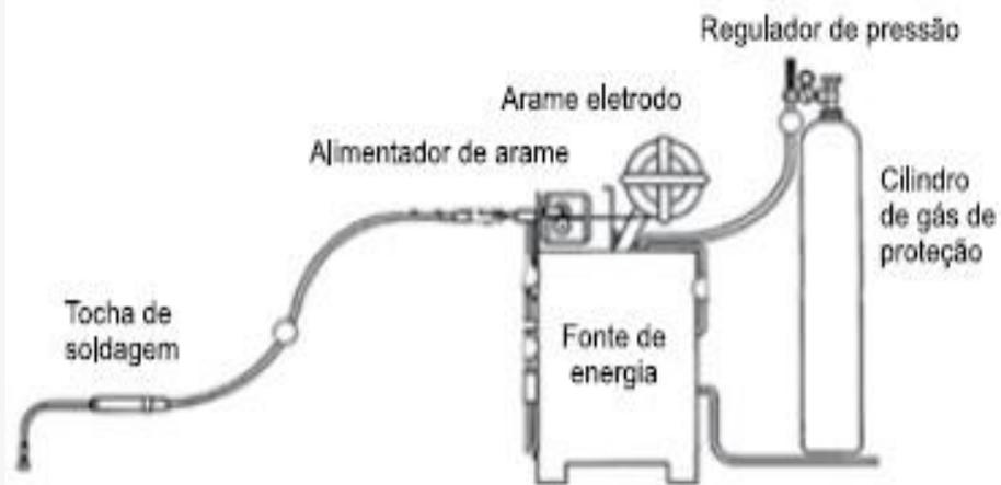
Para unir metais, o serralheiro necessita de uma máquina de solda. Considerando o desenho, o processo de soldagem apresentado é conhecido pelo nome de:
